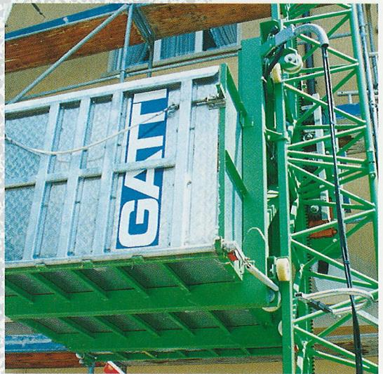
Die Bedienung erfolgt von unten. Dank Magnetschaltern können die einzelnen Stockwerke präzise angefahren werden.
